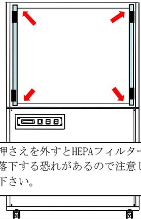
押さえを外すとHEPAフィルターが落下する恐れがあるので注意して下さい。
