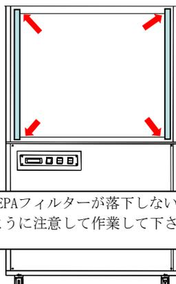
⑥パンチングパネルを取り付けて2箇所のビスで固定します。
